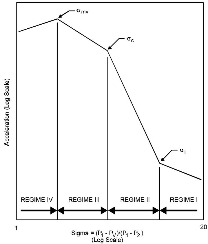
**Figure 1 — Cavitation parameter plot**
